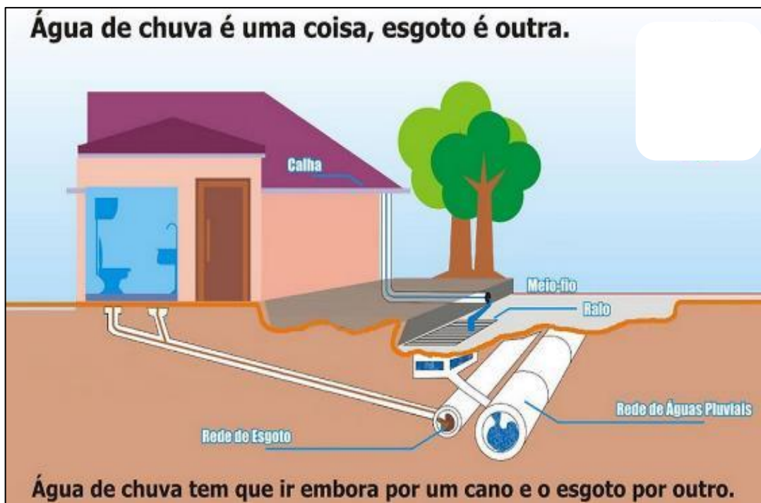
Figura 88 - Esboço do sistema de drenagem e esgoto
